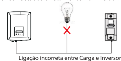
Ligação incorreta entre Carga e Inversor
